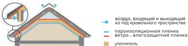
Рис. 1. Устройство вентиляции мансарды
